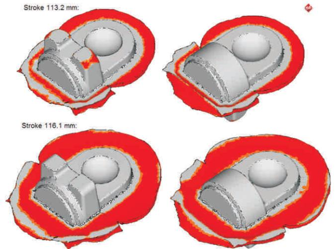
**Fig. 4: Die filling finisher die**
